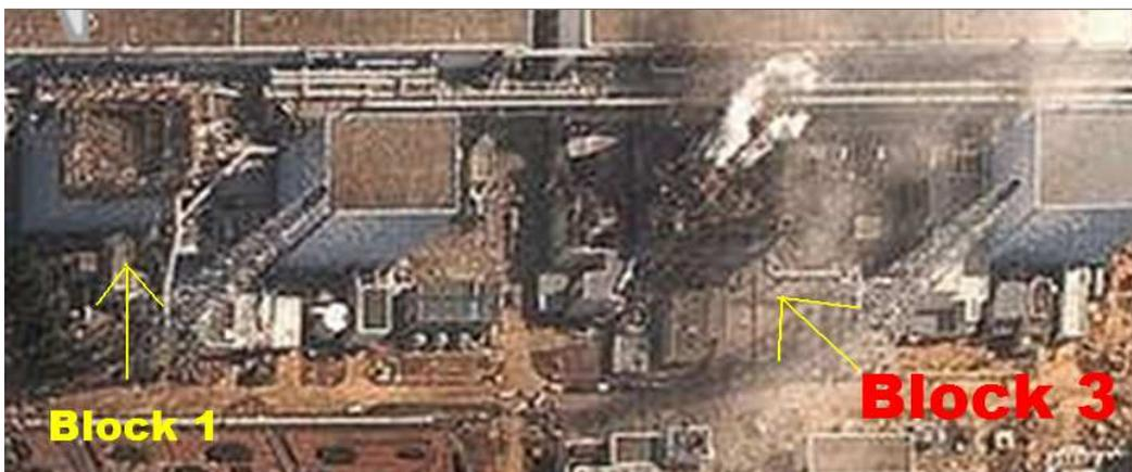
(Bild 1 von bild.de<sup>10</sup> : Auf diesem Bild könnte man bei Block 1 noch eine intakte Sicherheitshülle vermuten, bei Block 3 viel weniger. Die Zerstörungen in Block 3 sind weitaus größer)
