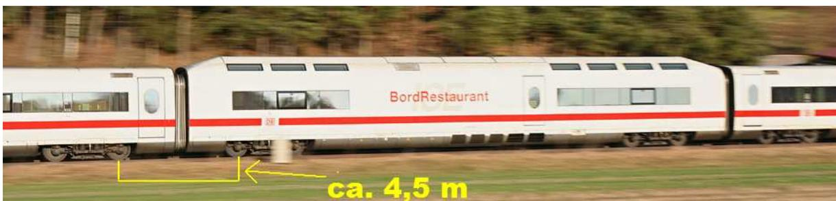
(Der Abstand zwischen der hintersten Achse eines ICE-Waggons und der vordersten Achse des darauffolgenden Waggons beträgt ca. 4, 5 m.)
