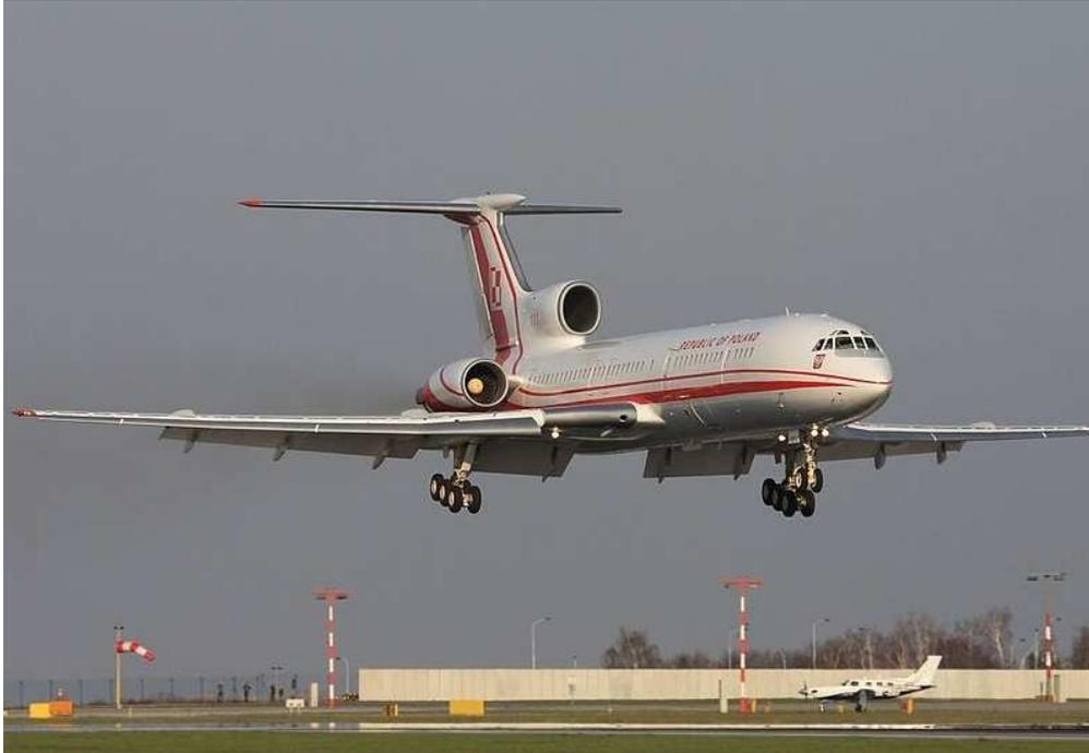
(Die Tupolew Tu-154 hat eine Spannweite von 37, 55 m, eine Länge von 47, 92 m und eine Höhe von 11, 40 m<sup>23</sup>)
