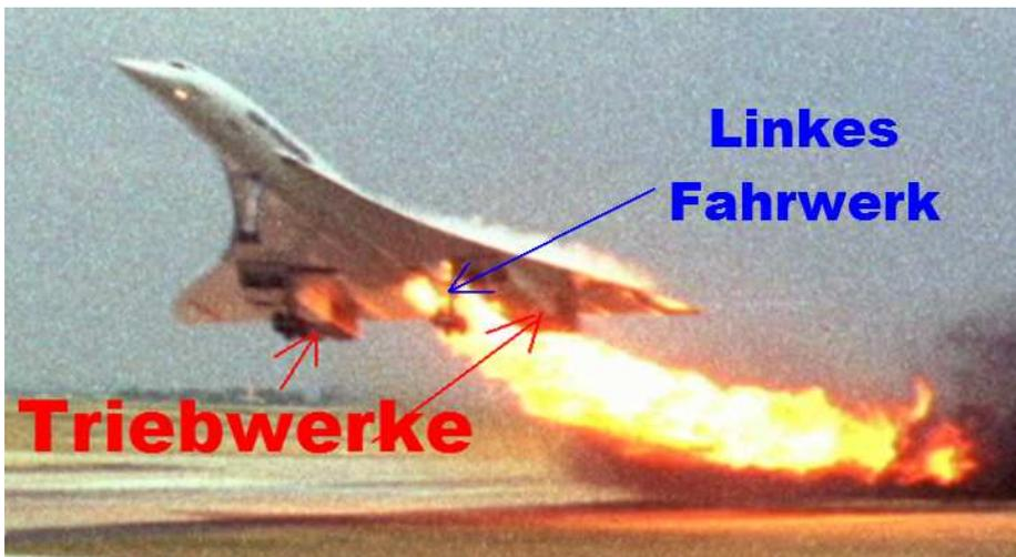
(Das linke Fahrwerk ist ausgefahren, das rechte Fahrwerk aber nicht!)
