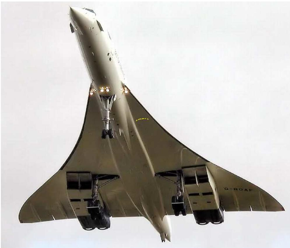
(Die Concorde von unten mit der ungefähren Stelle [gelb] des angeblichen Lochs im Tank, aber nicht in der Tragfläche. Man achte auf den relativ schmalen Fahrwerksschacht. Die Flügelspannweite beträgt 25,6 m.)
